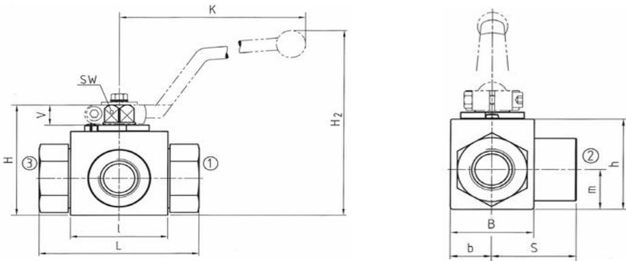
**Eingangsdruck nur über den mittleren Anschluss**
